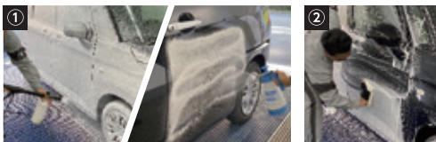
①スノーフォームランスや蓄圧式泡洗浄機などの泡フォームガンで泡を噴霧 ②ムートングロープで洗浄~すすぎ
