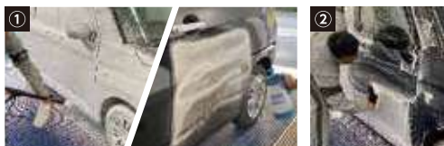
①スノーフォームランスや蓄圧式泡洗浄機などの泡フォームガンで泡を噴霧 ②ムートングローブで洗浄～すすぎ
