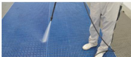
水のハネ返りが少なく、床面が濡れないのでスリップ防止効果があります。また、車両移動時に通路や他の作業スツールへの水の持ち込みを減らせます。
