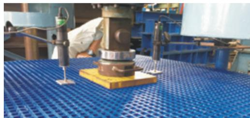
荷重条件: 横断側溝用ミゾ幅400mm
