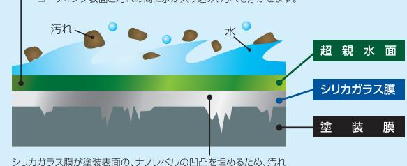
シリカガラス膜が塗装表面の、ナノレベルの凹凸を埋めるため、汚れなどがこびりつく隙間が無くなります。
