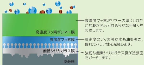
クリスターPRIMEは、最先端化学技術により「無機シリカガラス膜+高密度フッ素膜+フッ素ポリマー膜」の3層を化学的に結合した、ボディコーティングのハイエンドタイプです。
