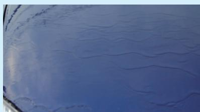
クリスタークォーツ【親水タイプ】の対水接触角は、一般的の親水系ガラスコーティングの30°前後を大幅に下回る10°以下。この超親水面により、セルフクリーニング効果が生まれます。まとまった雨が水の膜となり、ボディに付着した汚れを洗い流してくれます。
