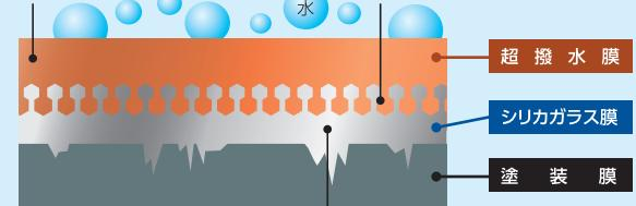
強靭なシリカガラス膜が、塗装表面にあるナノレベルの凹凸を埋めて平坦にし、汚れがこびりつくのを防ぎます。
