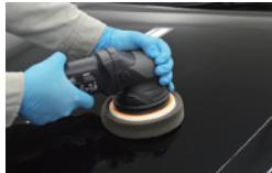
キズ埋めコンパウンドと大振動ダブルアクションボリッシャーで、施工面の下地を整えます。
